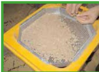
Les "boulettes" souillées restent sur le tamis, la fibre inutilisée est recyclée.
