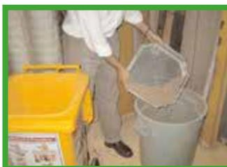
Jeter les "boulettes" dans un conditionnement prévu pour les DIS (Déchets Industriels Spéciaux). Les hydrocarbures sont retenus dans la fibre.
